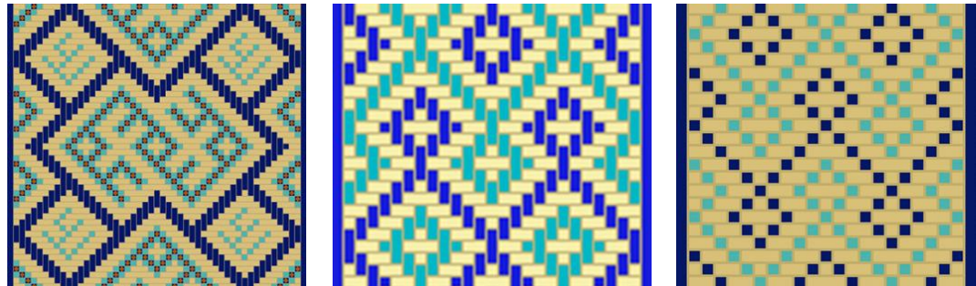
تصویر ۲. سمت راست معقلی یکرگی، وسط معقلی کشیده‌متن و چپ معقلی سه‌رگی (در واژه محمد و نیم‌لوزی‌های اطراف) که در نماهای مختلف بنا به‌کار گرفته شده‌اند (تزیینات بازطراحی شده توسط). منبع: نگارنده.
